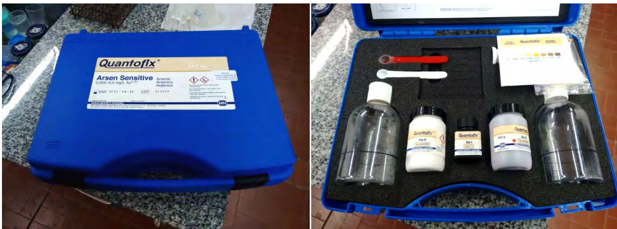
Figura 55. Equipo Quantofix® Arsen Sensitive de MACHEREY-NAGEL GmbH & Co para medición de la concentración de arsénico en terreno.
